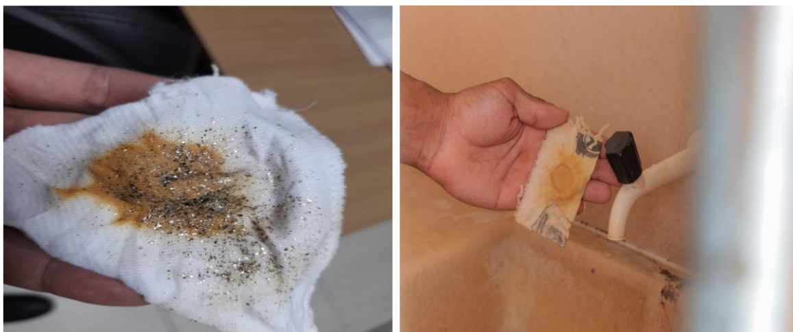
Figura 16 – Foto com as impurezas que saem da água disponibilizada na instituição
